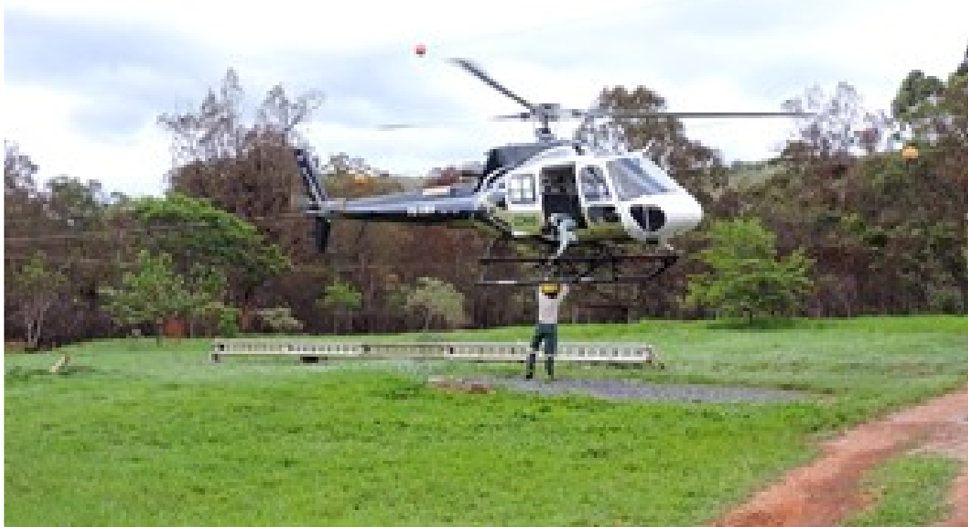
Figura 9 – Engate do cabo de aço no gancho Cargo Hook do helicóptero
