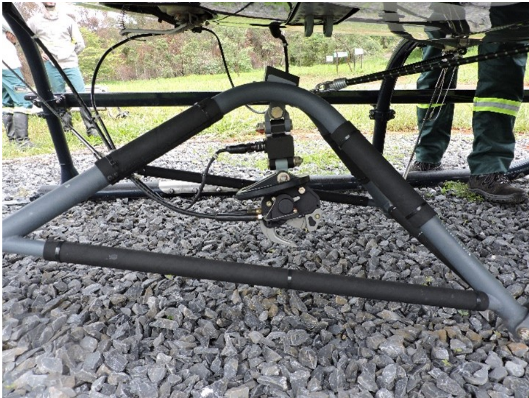
Figura 7 – Dispositivo Gancho de Carga (Cargo Hook) na base do helicóptero.
